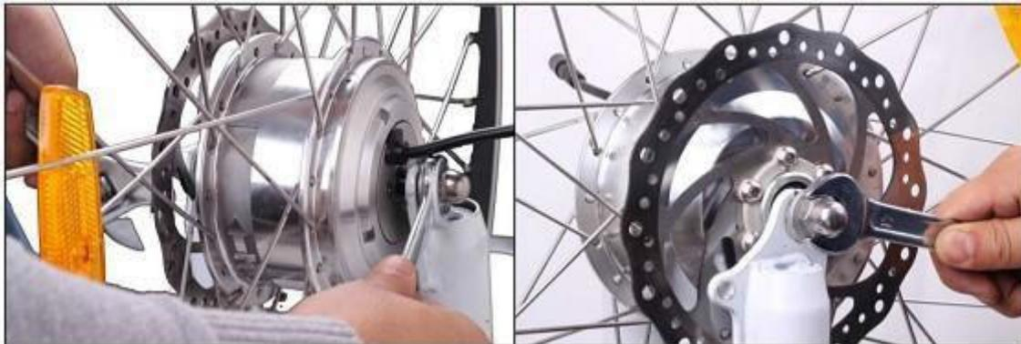
6. Justieren Sie den Bremsattel und ziehen Sie die Schrauben fest.
