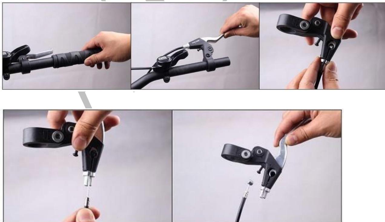
2. Montieren Sie die Bremsleitungen an den neuen elektrischen Bremshebel
