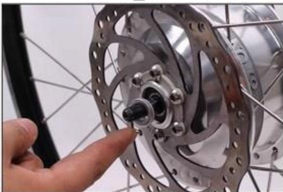
4. Schieben Sie die Abstandshalter auf die Achse und setzen Sie den Motor ein.
