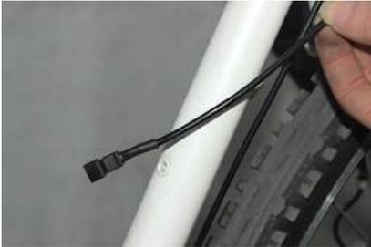
Bei dem abnehmbaren PAS (auf der linken Seite des Fahrrads installiert) ist die Kurbelarmentfernung nicht erforderlich.
