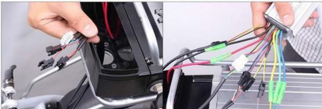
5. Schieben Sie den Controller in die Box und montieren Sie diese
