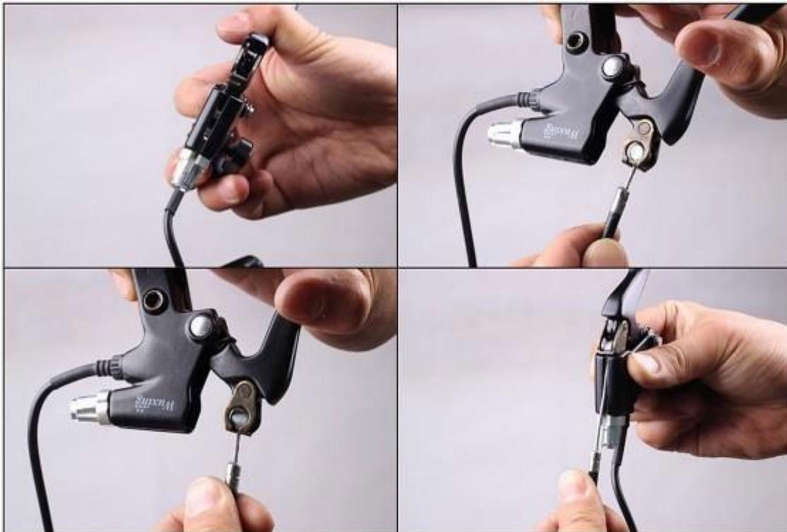
3. Bringen Sie die elektrischen Bremshebel am Fahrrad an und ziehen Sie die Schrauben fest (links und rechts)
