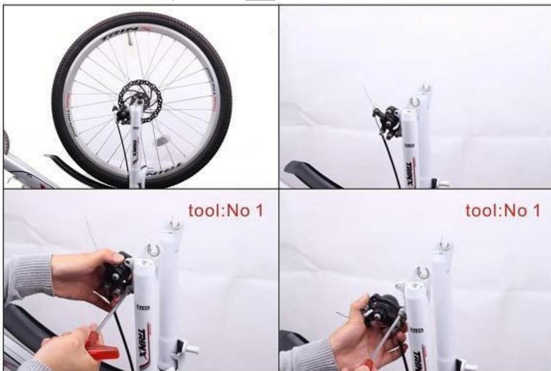
2. Demontieren Sie die Original-Disc und installieren Sie diese auf dem Motor.
