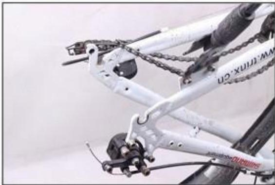
2. Montieren Sie die Bremscheibe und den Freilauf am Motor.
