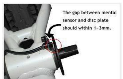
4. Bringen Sie die Kurbel und den Arm an und ziehen Sie das Sensorkabel am Fahrrad fest.
